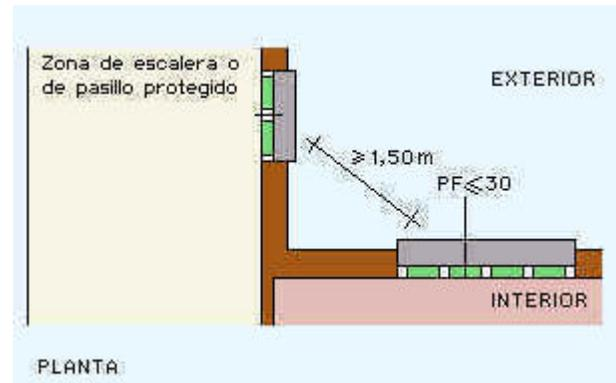
Cuando exista más de una escalera protegida con arranque en un espacio de una planta de salida del edificio que cumpla las condiciones anteriores, una de ellas podrá carecer de compartimentación en dicha planta.
